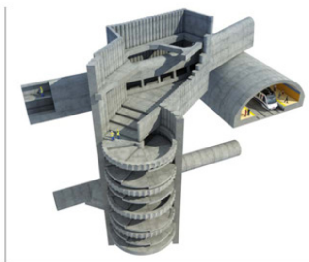
Conexión nuevo colector B con colector B primitivo Abroñigal
