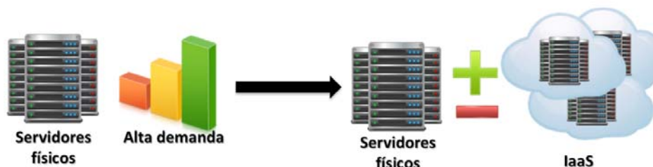
Figura 6. Esquema del sistema de absorción de picos adicionales de demanda
